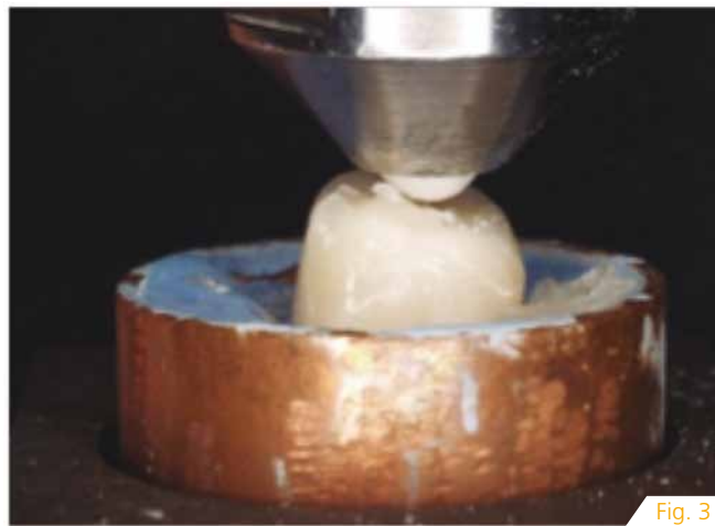
Restauración fracturada tras el ensayo
