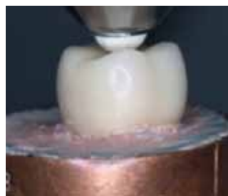
Figura 2. Contacto de la muestra con el aplicador de carga
