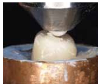
Figura 3. Restauración fracturada tras el ensayo.
